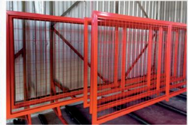
Processo: limpeza da peça com banho químico; secagem; aplicação tinta em pó; cura no forno a 200 °C
